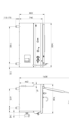
E - přívod napětí 400V WD - přívod vody do duplikátrou W - přívod vody
